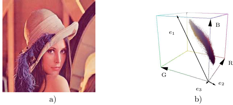
FIG. 3.2 – Image test Lenna a) et son multi-ensemble b) avec les 3 vecteurs propres (e_1, e_2, e_3) de sa matrice de covariance. La longueur de chaque vecteur est proportionnelle à sa valeur propre.
