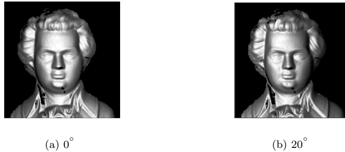
FIG. 2.21 – Une image d'un buste de mozart prise avec illuminant de face (a) et illuminant à 20^\circ . La reconstruction est affichée sur la Figure 2.22.
