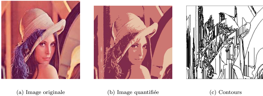
FIG. 4.52 – Contours (c) des composantes connexes obtenues à partir d'un algorithme de quantification (b) appliqué sur l'image Lenna (a).
