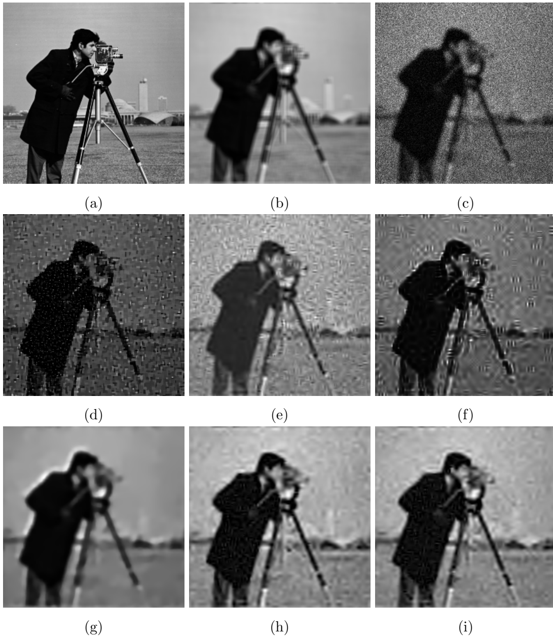
FIG. 4.6: Déconvolution du cameraman (Intensité \leq 30 ). (a) Originale, (b) Convoluée, (c) Convoluée & bruitée, (d) RL-TV [Dey et al., 2004], (e) NaiveGauss [Vonesch et Unser, 2007], (f) RL-MRS [Starck et Murtagh, 2006], (g) FTITPR [Willett et Nowak, 2004], (h) PoissonStab, (i) PoissonNS.
